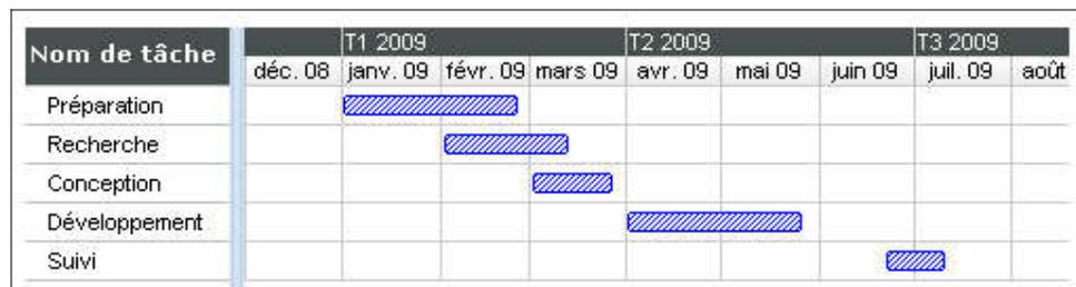
Le **planning** détermine une **suite de tâches** à accomplir. On peut utiliser des **outils** comme le **diagramme de Gantt** ou le **diagramme Pert**. Ces outils permettent d'**organiser** les différentes **tâches sans temps mort**, et **terminer le projet en réduisant les délais**.
